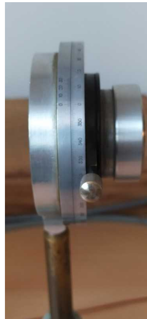
objímka polarizátoru 1 se stupnicí pro kontrolované otočení polarizátoru
