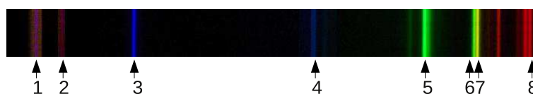
Obrázek 9.4: Upravená fotografie spektra rtuťové výbojky. Očíslovány jsou čáry, jejichž vlnové délky jsou uvedeny v tabulce 9.1.
