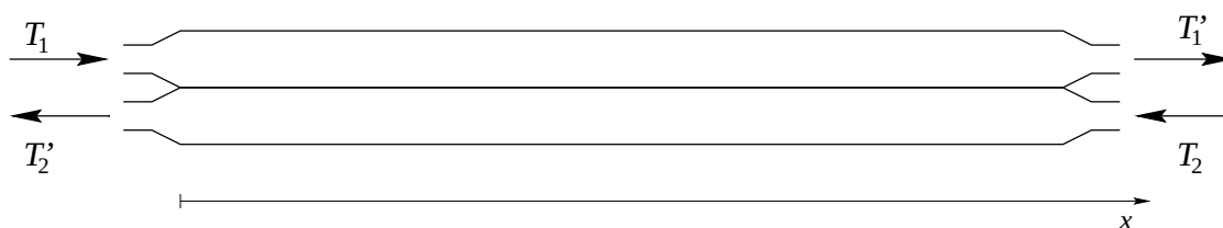
Obrázek 1: Označení vstupních a výstupních teplot kapalin u protisměrného chladiče
