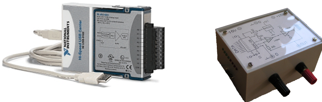
Obrázek 14: Dva D/A převodníky: vlevo profesionální 4-kanalový 16-bitový převodník USB-9263 firmy National Instruments, vpravo jednoduchý osmibitový D/A převodník MDAC-08
