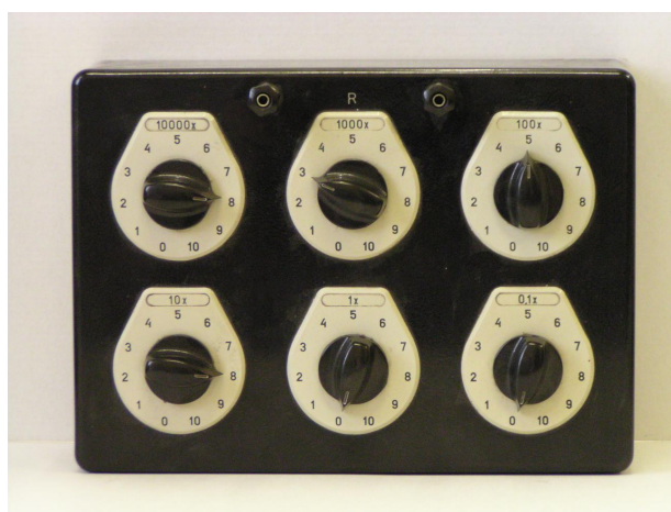
Obrázek 13: Odporová dekáda s nastavenou hodnotou 83 580 \Omega .
