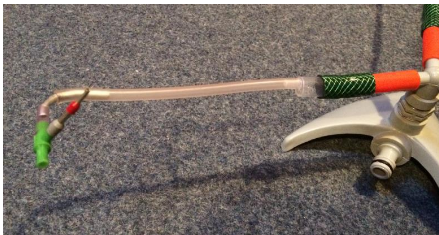
Obr. 3 Detail ramene – uspořádání prvků postupně od zahradní rotační zavlažovací stříčky: hadice 0,5 palce, uřezaná inj. stříkačka 5 ml, PVC trubička 6/4 délky 120 mm, hliníková tubička 4 mm ohnutá do L, PVC trubička 6/4, T kus akvaristika vzduchování, tryska – dvě lisovací kabelové dutinky 4 mm, 2 mm
