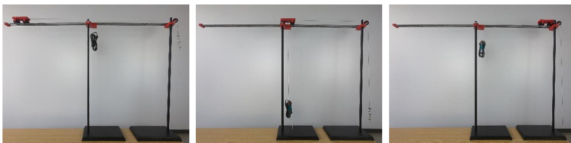
Obr. 3. Poloha vozíku, teploměru a závaží: vlevo na začátku pohybu, uprostřed v polovině pohybu, vpravo na konci pohybu.
