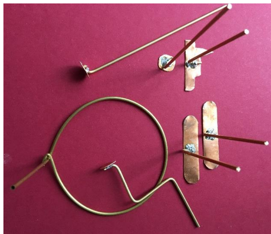
Obr. 1. Vyrobené různé elektrody na demonstraci elektrického pole.
