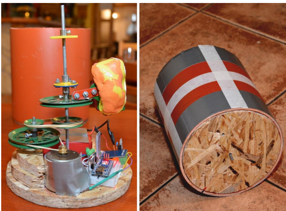
Obr. 5. Rozložení součástek uvnitř modelu robota BB8 a výsledný robot
