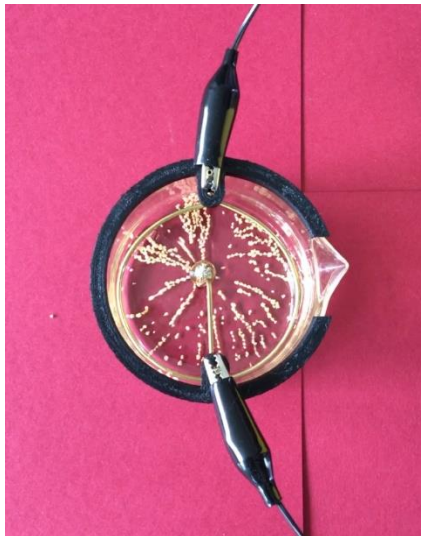
Obr. 5. Elektrické pole v okolí nabitého tělesa kulového tvaru.
