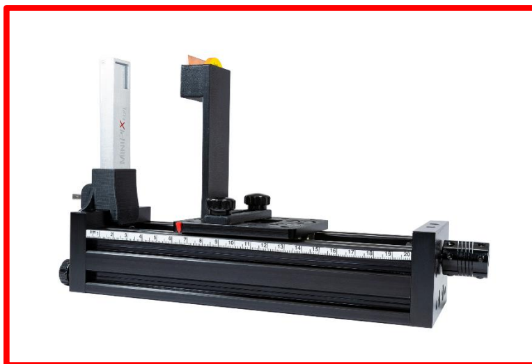
Obr. 4. Detektor MiniPIX EDU a zářič v posuvné lavici Radiation Education Kit. Zdroj [2].
