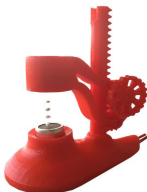
Obr. 10. Mnou vytištěný držák na 3D tiskárně dle vzoru [8].
