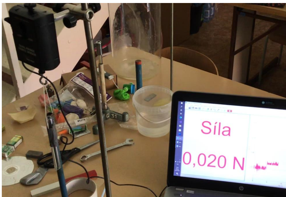
Obr. 2. Uspořádání experimentu s magnetem padajícím trubcí
