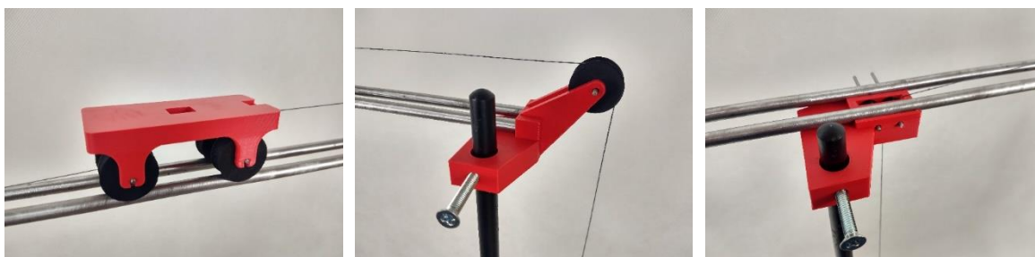
Obr. 2. Vytištěné části konstrukce: vlevo vozík, uprostřed pevná kladka na konci dráhy, vpravo pevné kladky ve středu dráhy.
