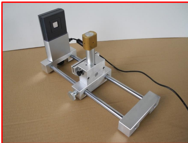
Obr. 3. Detektor a americiový zářič ŠZZ alfa v posuvné lavici MX-10 Edukit.
