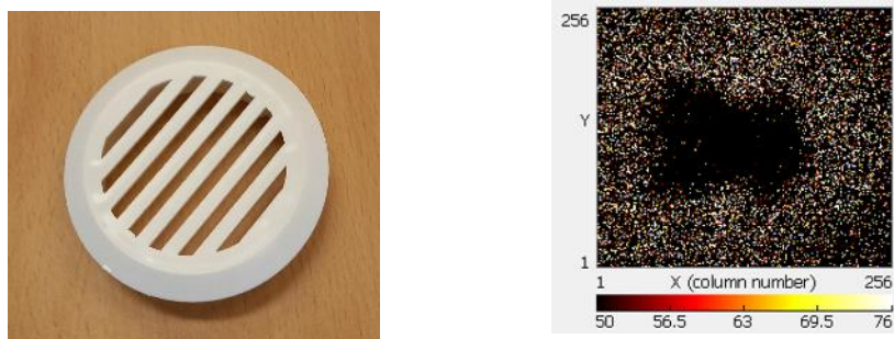
Obr. 6. Mřížka pro filtraci vzduchu (vlevo) a ukázka radiografického snímku (vpravo). Pro demonstraci radiografie budou v sadě vzorky s ukrytými kovovými předměty, které bude možné zobrazit nejlépe pomocí DZZ gama tak, jako to vidíme na obr. 6 vpravo.
