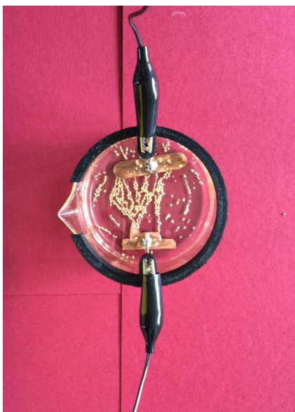
Obr. 6. Elektrické pole v okolí tělesa s hrotem (věž kostela).
