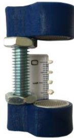
Obr. 14. Měření vlnové délky pomocí akustické levitace.
