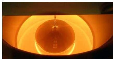
Obrázek 2.5: Pohled do tažičky na rostoucí monokrystal křemíku (převzato z [18]).
