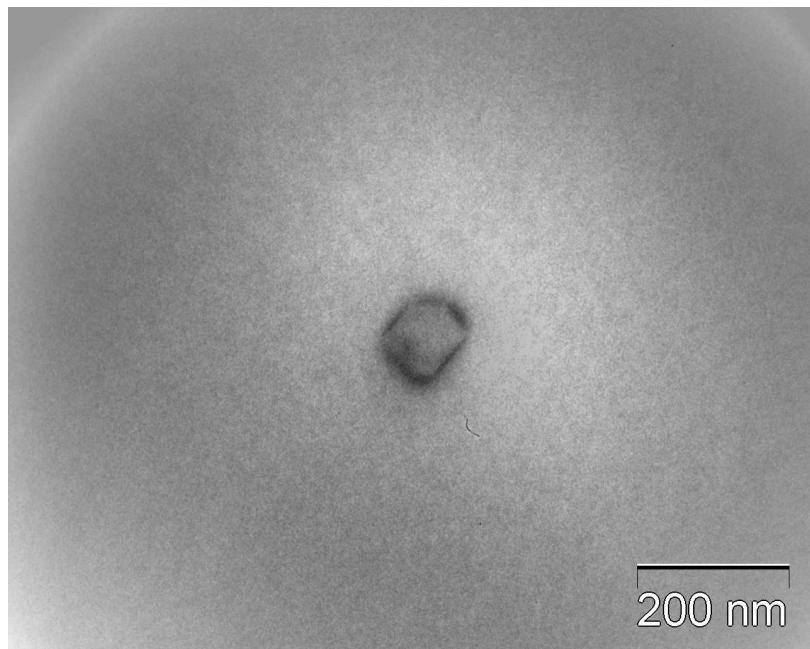
Obrázek 4.10: Obrázek pořízený pomocí TEM na žíhaném vzorku CZ Si (B8 ze čtvrté série). Můžeme zde vidět kyslíkový precipitát o plošných rozměrech přibližně  $100 \times 100$  nm.
