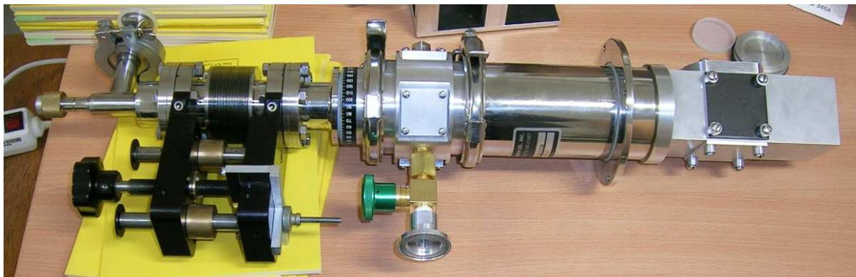
Obrázek 4.5: Heliový kryostat Janis ST-100-FTIR.
