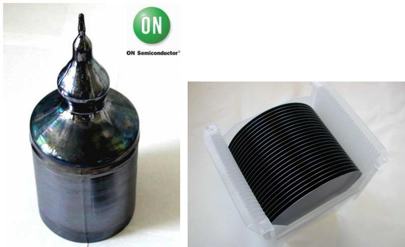
Obrázek 6.5: Vlevo je část křemíkového monokrystalu legovaného dusíkem, který byl vyroben Czochralskoho metodou ve firmě ON Semiconductor Czech Republic a vpravo několik desek z tohoto krystalu [7].
