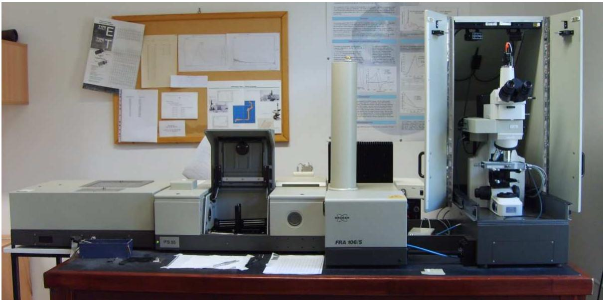
Obrázek 4.2: Fourierovský spektrometr Bruker IFS 55/S Equinox (uprostřed) s ramanským modulem FRA 106/S. Vpravo je připojen Ramanoskop R590 a vlevo infračervený elip- sometr (MIR).
