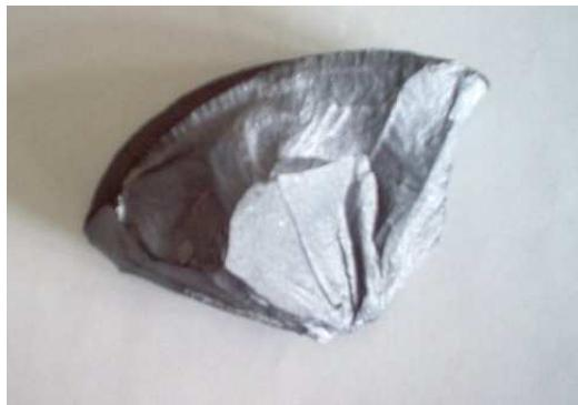
Obrázek 2.2: Polykrystalický Si pro růst monokrystalu křemíku Czochralskoho metodou (převzato z [1]).
