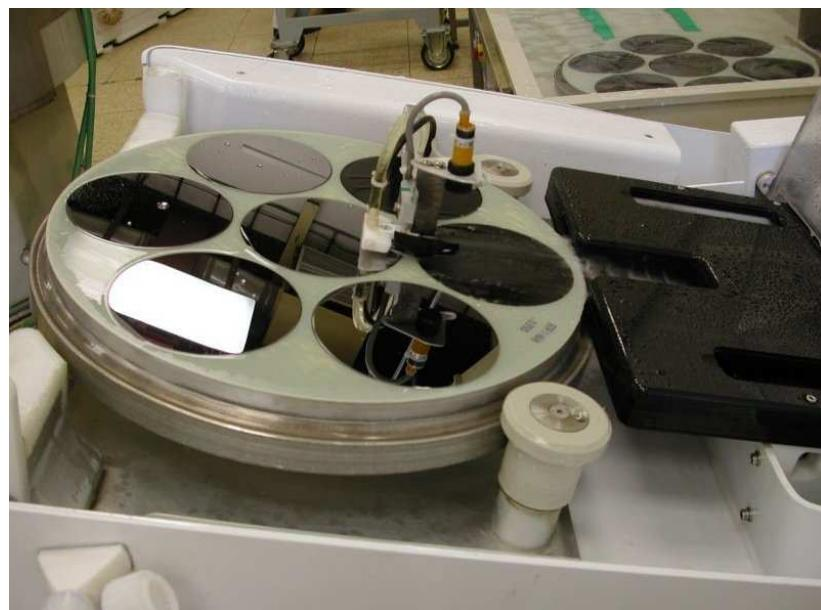
Obrázek 2.7: Leštění křemíkových desek (převzato z [18]).
