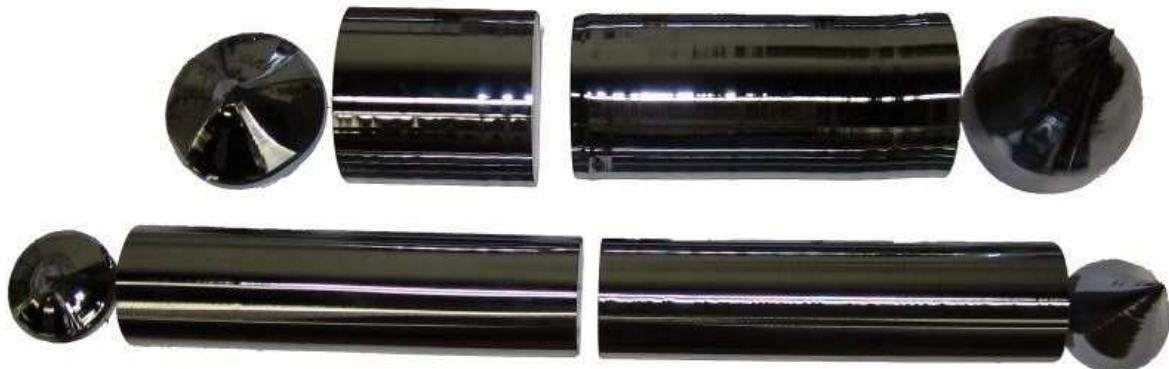
Obrázek 2.6: Části 6" a 4" křemíkových ingotů získaných Czochralskoho tažením (převzato z [18]). Zleva: hlava, tělo (dvě části) a špice.
