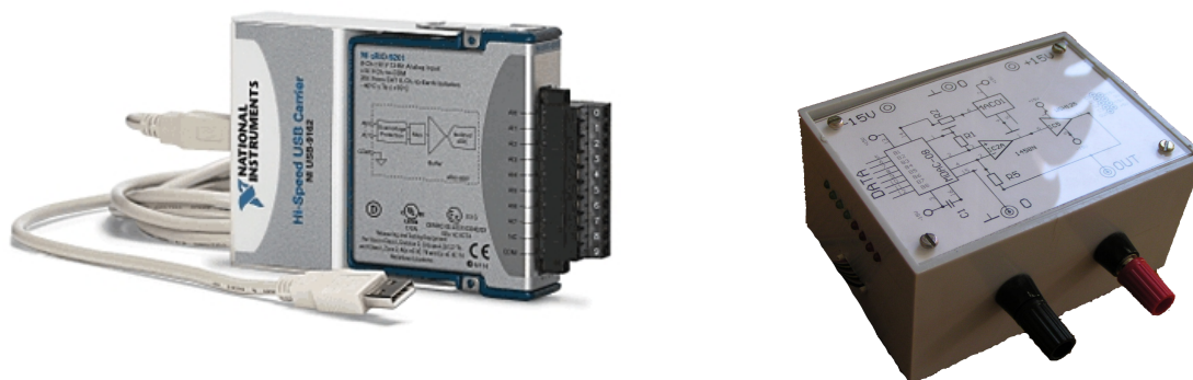
Obrázek 13: Dva D/A převodníky: vlevo profesionální 4-kanálový 16-bitový převodník USB-9263 firmy National Instruments, vpravo jednoduchý osmibitový D/A převodník MDAC-08
