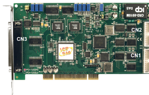
Obrázek 14: Měřicí karta ICP DAS PCI-1202LU
