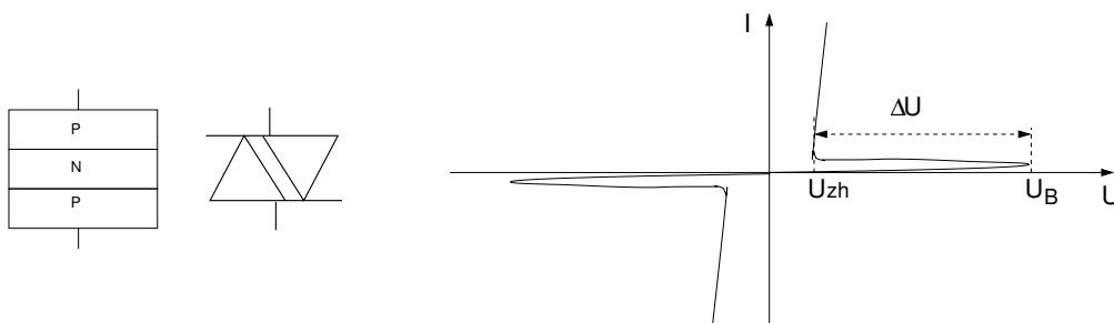
Obrázek 1: Vlevo – schéma uspořádání a symbol diaku. Vpravo – voltampérová charakteristika diaku.
