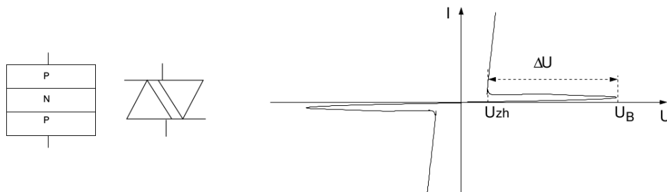
Obrázek 1: L - schéma uspořádání diaku. P - voltampérová charakteristika diaku.
