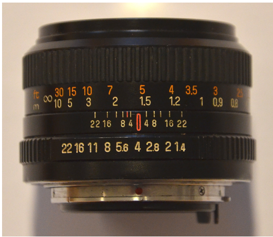
Obrázek 3: Fotografický objektiv se světelností 1 : 1.4 a ohniskovou vzdáleností 50 mm. Stupnice nejnižší je clonová, nejvyšší je ostřicí kalibrovaná v metrech (bílá) a ve stopách (oranžová). Prostřední stupnice souvisí s hloubkou ostrosti.
