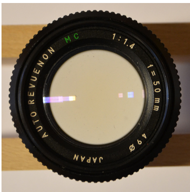
Obrázek 4: Tři různě nastavené clony na objektivu – zleva doprava 1.4, 4 a 16. Čím vyšší číslo, tím méně světla do objektivu přichází. Zdvojnásobení čísla zmenší množství světla na čtvrtinu, proto je stupnice geometrická posloupnost s kvocientem \sqrt{2} – posun o jedno číslo odpovídá snížení množství světla na polovinu.
