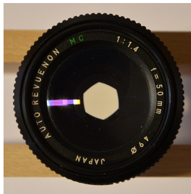
Obrázek 4: Tři různě nastavené clony na objektivu – zleva doprava 1.4, 4 a 16. Čím vyšší číslo, tím méně světla do objektivu přichází. Zdvojnásobení čísla zmenší množství světla na čtvrtinu, proto je stupnice geometrická posloupnost s kvocientem \sqrt{2} – posun o jedno číslo odpovídá snížení množství světla na polovinu.
